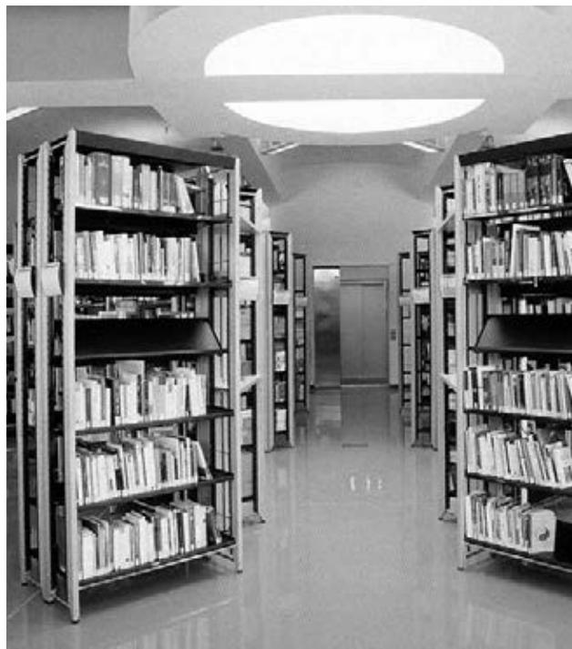
figura 294 Sistema scatolare a struttura puntiforme, monofronte, in tondini in acciaio e ripiani in lamiera o legno (Caimi).
